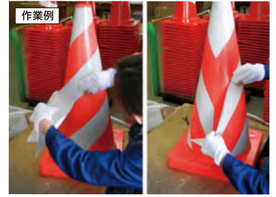
反射シートの貼り付けは、1本ずつ丁寧に手作業で行っております。(熱融着式反射シート使用)
